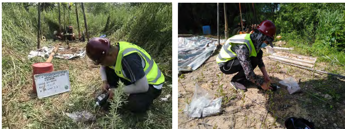
图 4.3-4 土壤样品 PID 快速检测现场图
